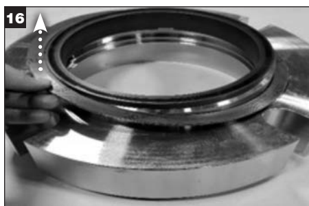
Rimuovere la guarnizione dall'adattatore ed eliminarla.
