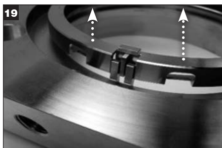
Rimuovere il condotto di azionamento dalla flangia; rimuovere i fermagli del condotto ed il deflettore di flusso dal condotto ed eliminarli.
