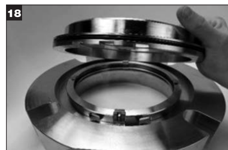
Rimuovere l'adattatore dalla flangia. Rimuovere l'O-ring dell'adattatore (Z) ed eliminarlo. Mettere da parte l'adattatore.
